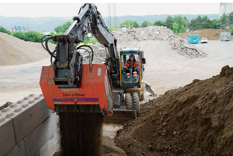
Maschinist Richard Vögele siebt mit dem Schaufelseparator am Radbagger Humus für den Kundenverkauf.
